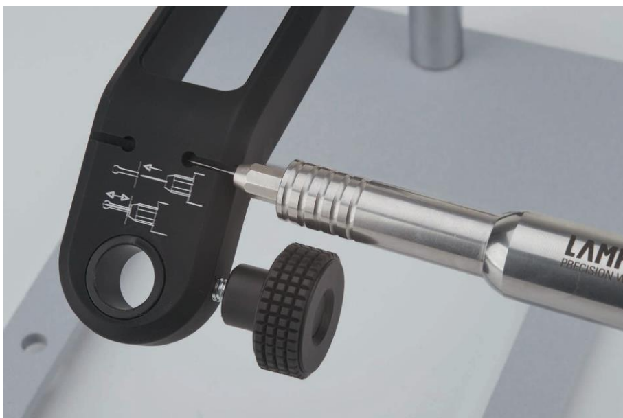
Рисунок 5.2. Регулировка длины электрода с помощью рычага для фиксации наконечника
